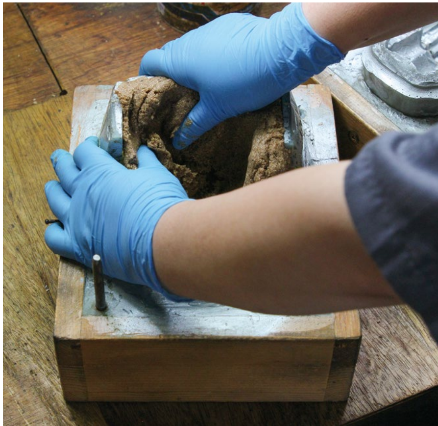
桐の粉と正麴糊を混ぜた桐塑を「釜」と呼ばれる型に詰めて、人形のボディを作ります。
