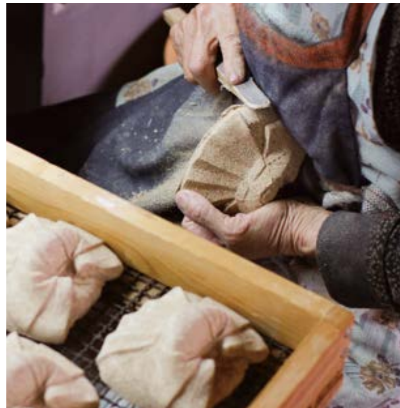
ボディのバリを取り、表面を補修するのも、ひとつひとつ職人の手作業でおこなわれます。
